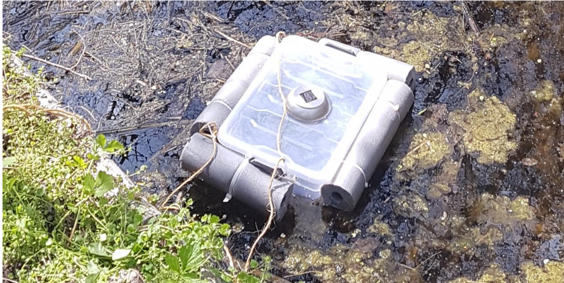
Abb. 4: Ausgebrachte Trichter-Lichtfalle für die Erfassung von Molchen
