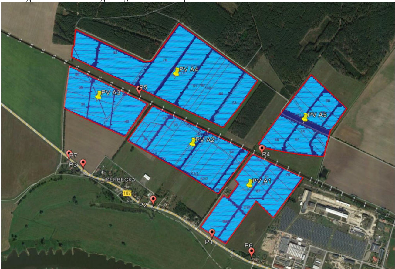
Bild 3.5.1: Exemplarisch gewählte Messpunkte P1 – P7 für die Analyse der Reflexionen (Quelle: Google Earth/SolPEG)
