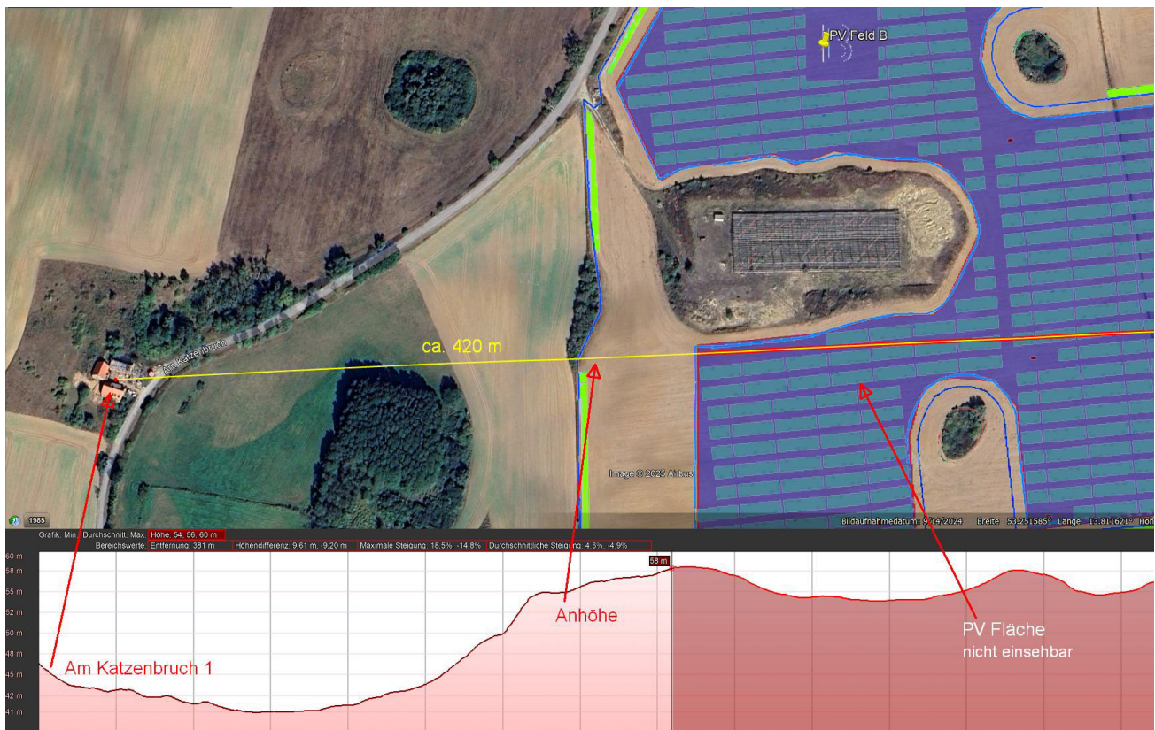
Bild 3.1: Geländeverlauf zwischen den westlich gelegenen Gebäuden und der PV-Anlage (Quelle: Google Earth / SolPEG)
