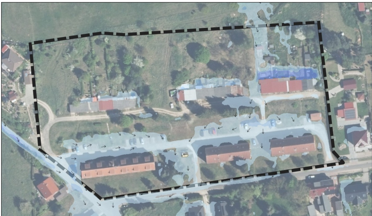
Abb. 9: Fließrichtung und Überflutungstiefe gemäß Starkregengefahrenkarte im Plangebiet Hintergrundkarte: © GeoBasis-DE/LGB, dl-de/by-2-0
