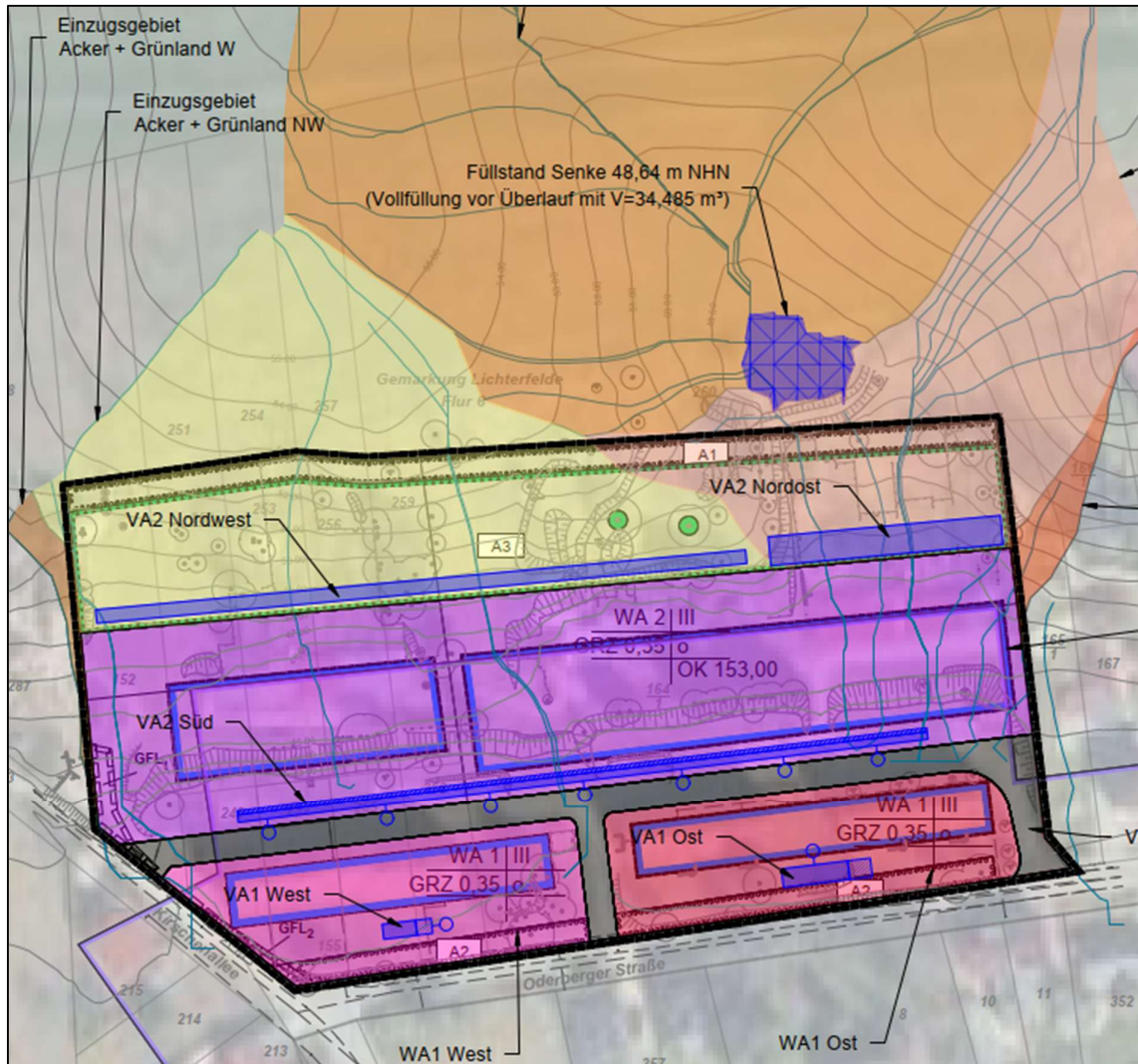
Abb. 7: Lage- und Flächenabflussplan (S. 8 Entwässerungskonzept)
