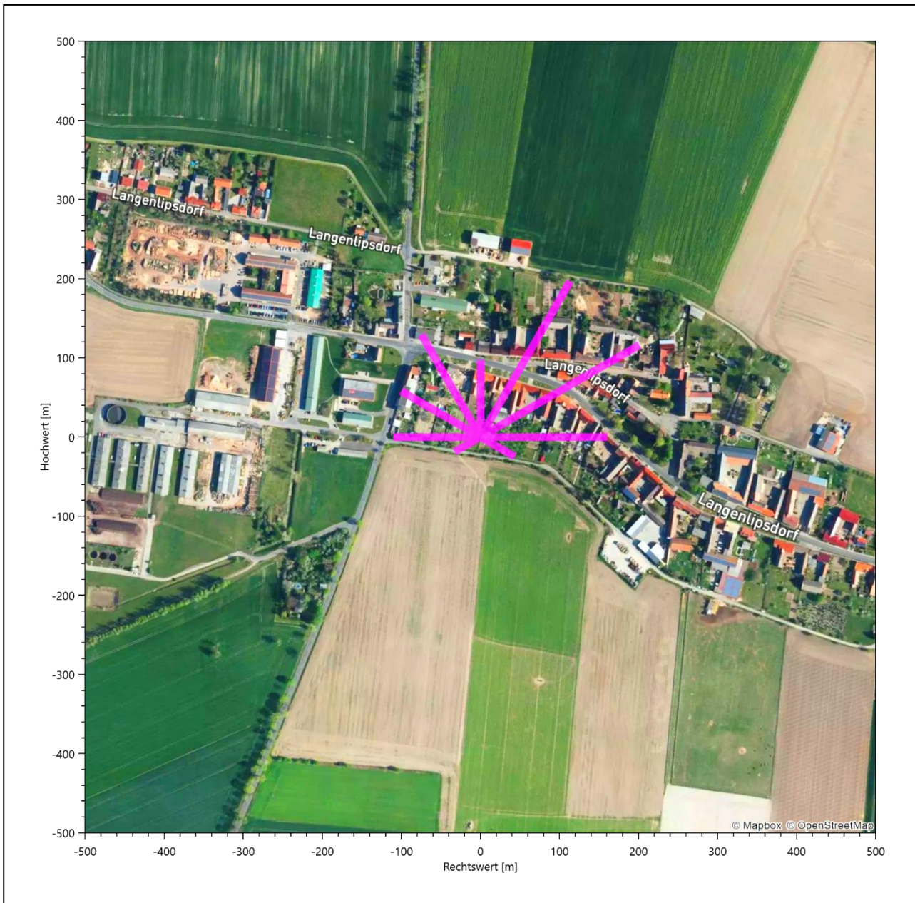
Abbildung 14: Verteilung der effektiven aerodynamischen Rauigkeiten auf die Windrichtungssektoren für die Station Langenlipsdorf
